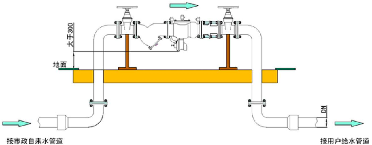
安装完毕启动使用时，为了防止剧烈震动造成内部零件移位和损伤，有必要遵循以下步骤：先关闭出口闸阀，慢慢打开进水闸阀，让水缓慢充满倒流防止器，打开各个测试球阀排除腔内的空气，待阀腔充满水后，再慢慢打开出水闸阀，让水充满整个管路。
