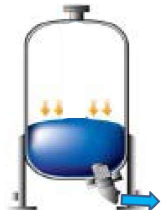
泵正常运行或/和水击保护运行
