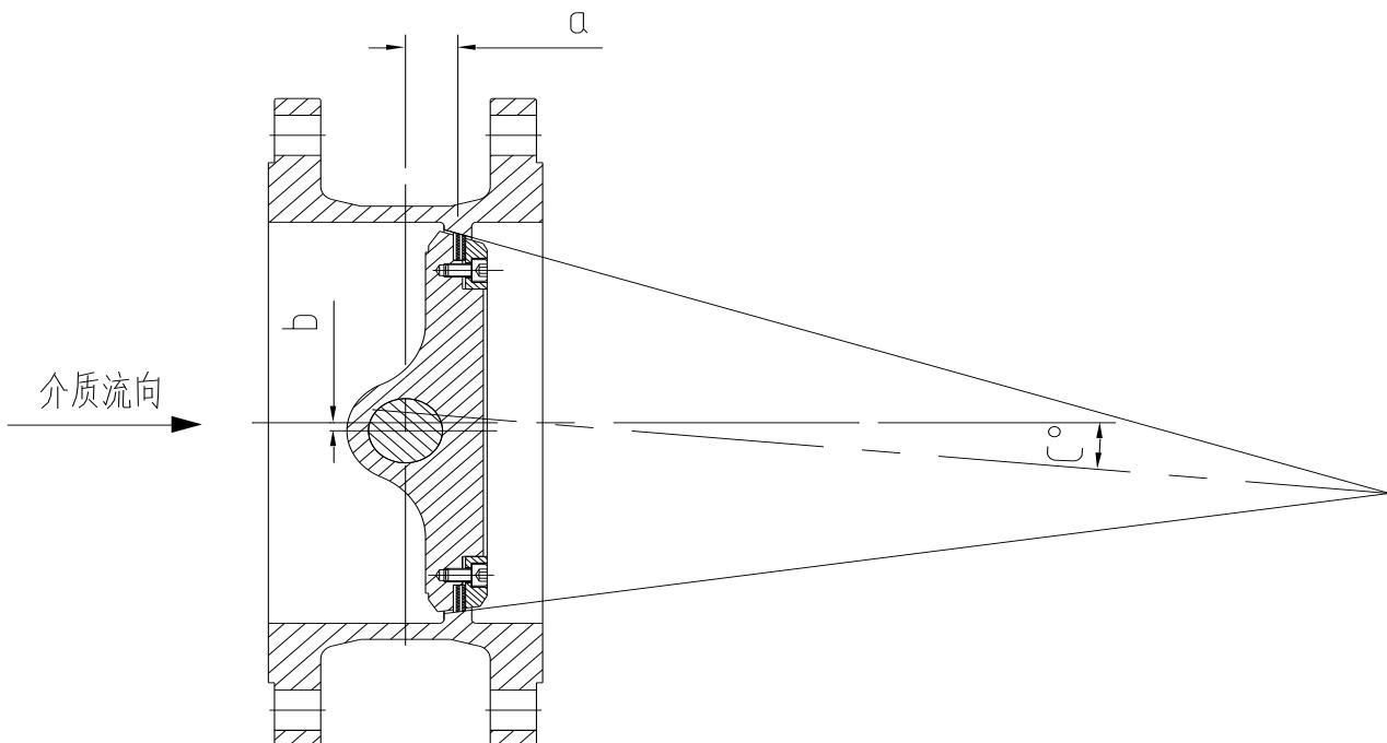
4、图示偏心的存在使得蝶板密封面同阀体密封面在启闭过程中不发生磨擦，使用寿命长。
